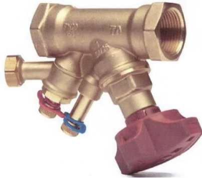
Bild 3.2.1 STAD-Ventil. Denna injusteringsventil har mätuttag som möjliggör flödes- och temperaturmätning. Viktigt att ventilen är rätt monterad och inte felvänd om mätfel ska kunna minimeras till ca 5%.
